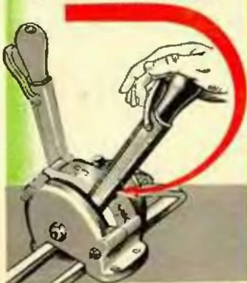
5. Открыть колпачки кнопок управления сбрасыванием бомб и снарядов.
