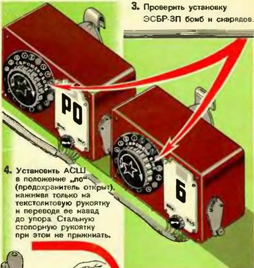
4. Установить АСЦ в положение „до“ (предохранитель открыт), нажимая только на текстолитовую рукоятку и переводя ее навод до упора. Стальную стопорную рукоятку при этом не прижимать.
