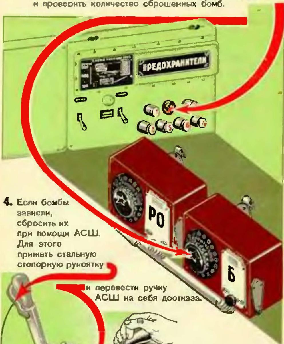
4. Если бомбы заклинили, сбросить их при помощи АСШ. Для этого прижать стальную стопорную рукоятку
